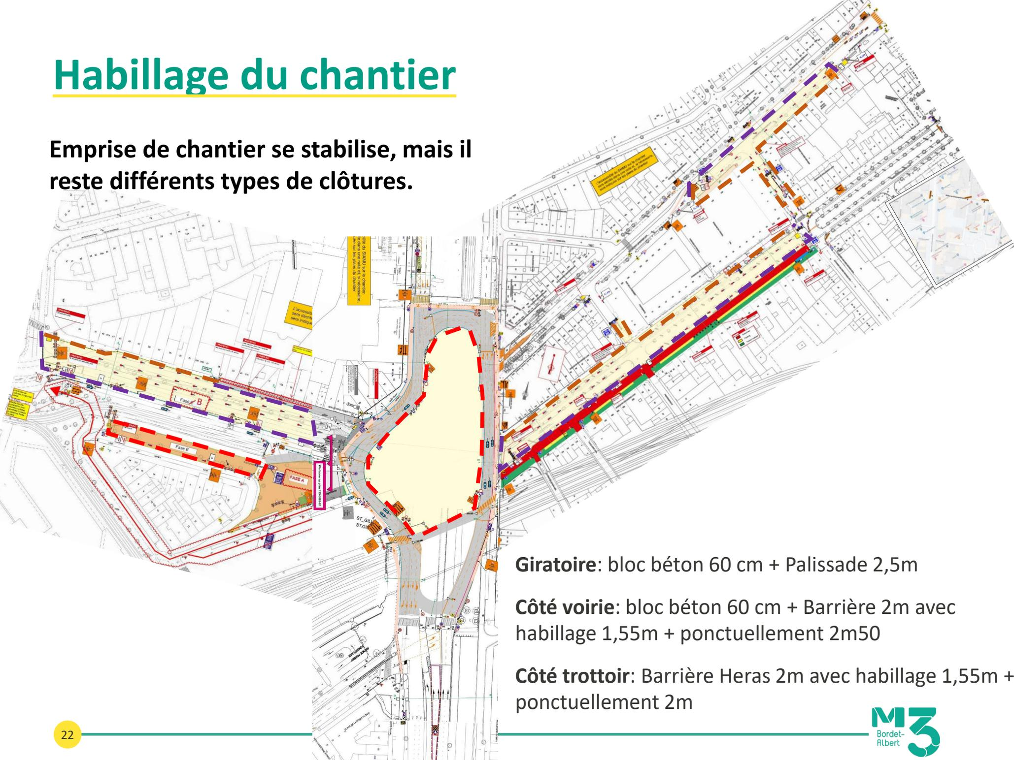
**Giratoire:** bloc béton 60 cm + Palissade 2,5m
