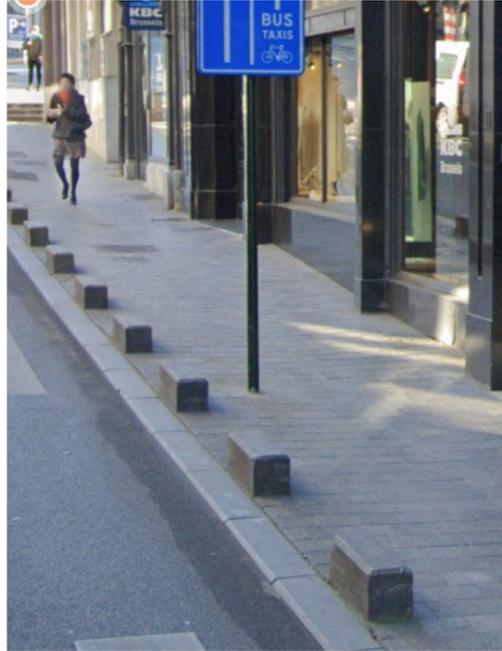
Dispositif anti-stationnement : bordures saillantes interrompues
